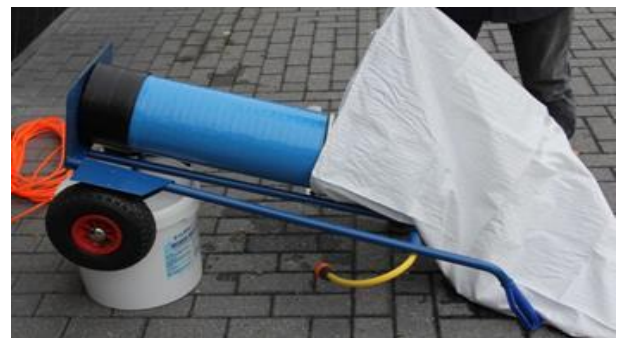
4. het uitlopen van de hars bevorderen door de steekwagen op te tillen
